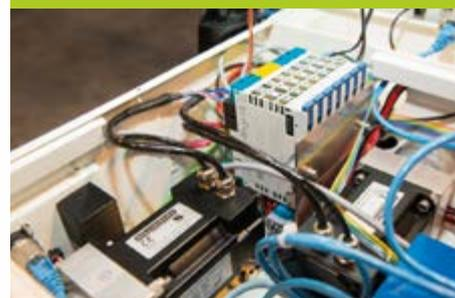
Anche all'interno dello stretto AGV PackMan 200, c'è spazio per il sistema S-DIAS, a prova di vibrazioni, con controllo del motion e Safety, oltre a due servomotori DC a bassa tensione, AKM.
