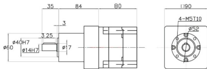
86型无刷电机配60行星减速机 1极
